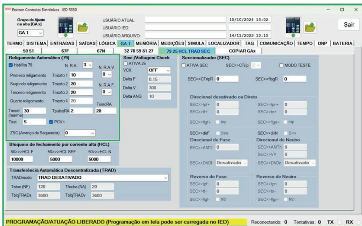
Figura 4.13: Religamento Automático (79) – Pasta GA (Grupo de Ajuste) – Detalhes no Capítulo 12
