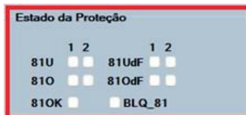
Figura 11.2: Sinalização da Proteção por frequência
