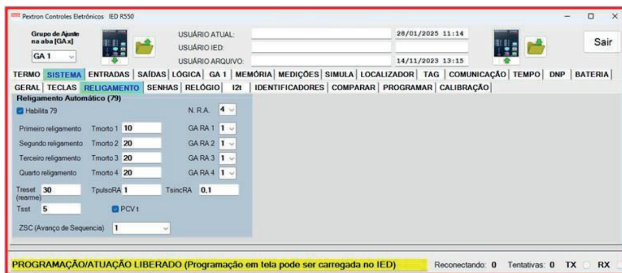
Figura 12.1: Pasta SISTEMA/RELIGAMENTO - parâmetros da unidade de religamento automático
