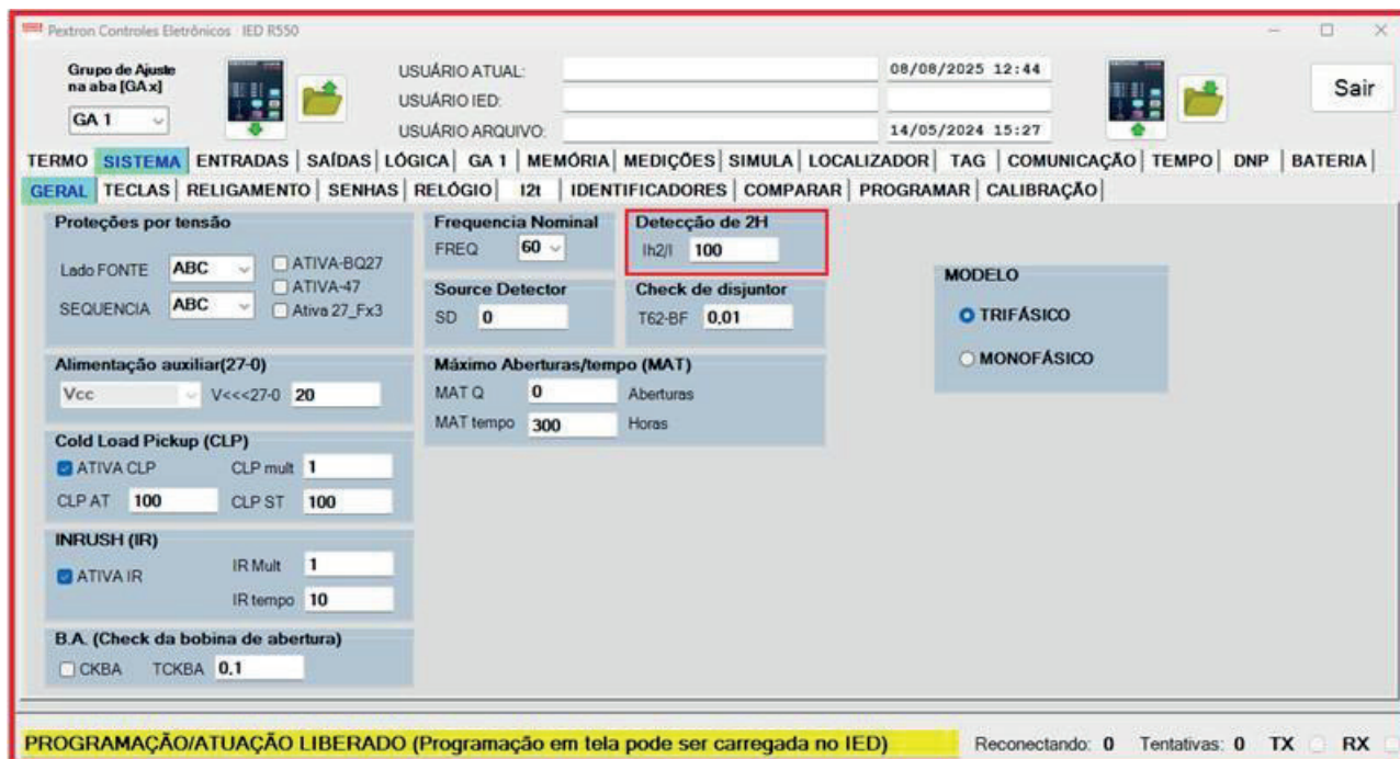
Figura 4.6: Pasta SISTEMA – GERAL sinalizado com o parâmetro da unidade de bloqueio por 2ª harmônica
