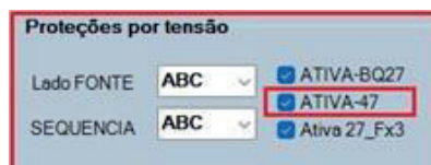
Figura 4.2: Protección de secuencia de fases.
