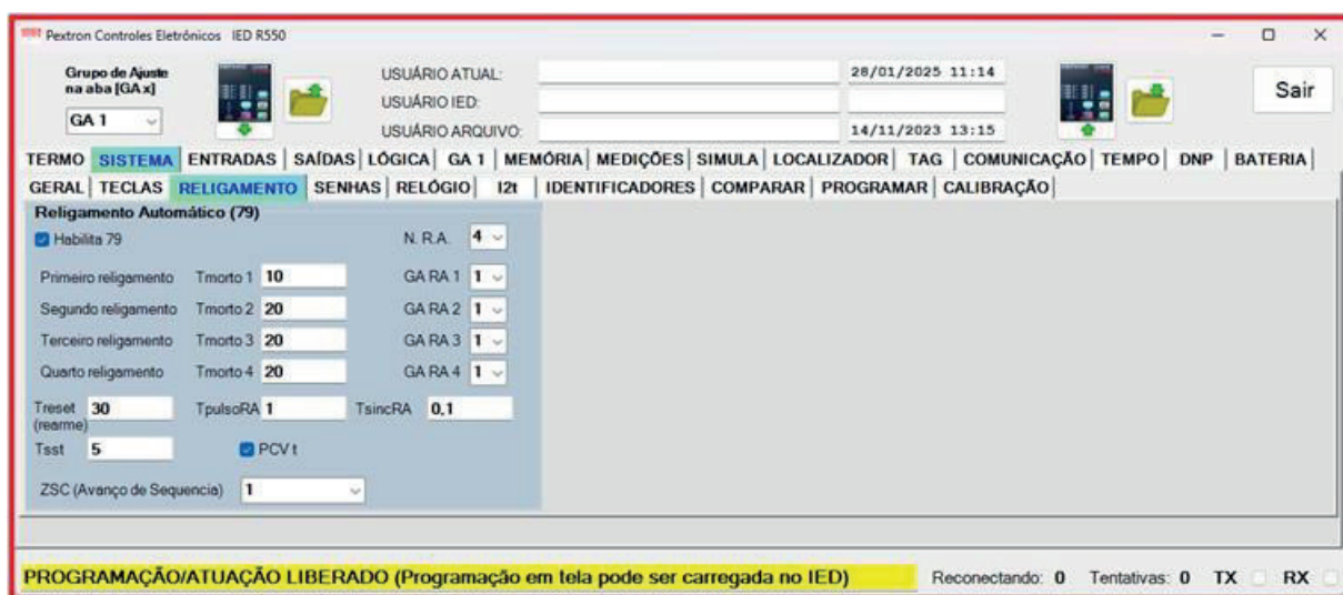
Figura 4.12: Carpeta SISTEMA - Reconexión automática
