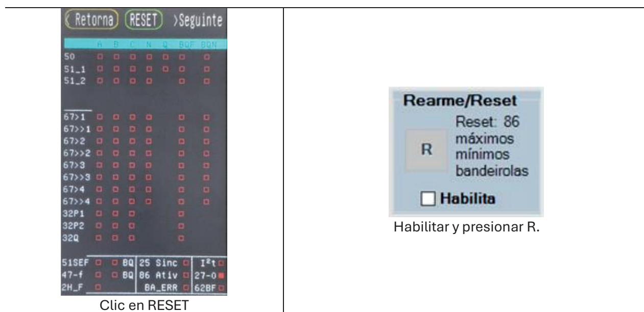
Figura 6.3: RESET vía IHM local y vía software aplicativo
