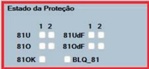
Figura 11.2: Señalización de la protección por frecuencia
