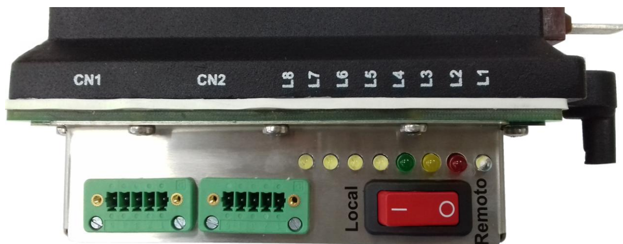
Figura 22: Terminais da comunicação serial
