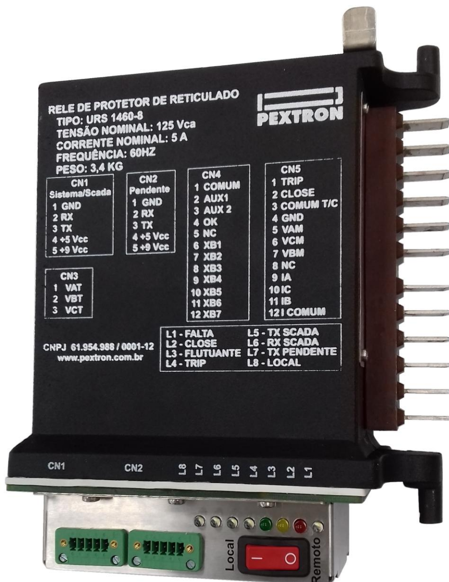
Figura 21: Bornes CN 1 e CN 2 de comunicação serial, led's de sinalização e chave Local.
