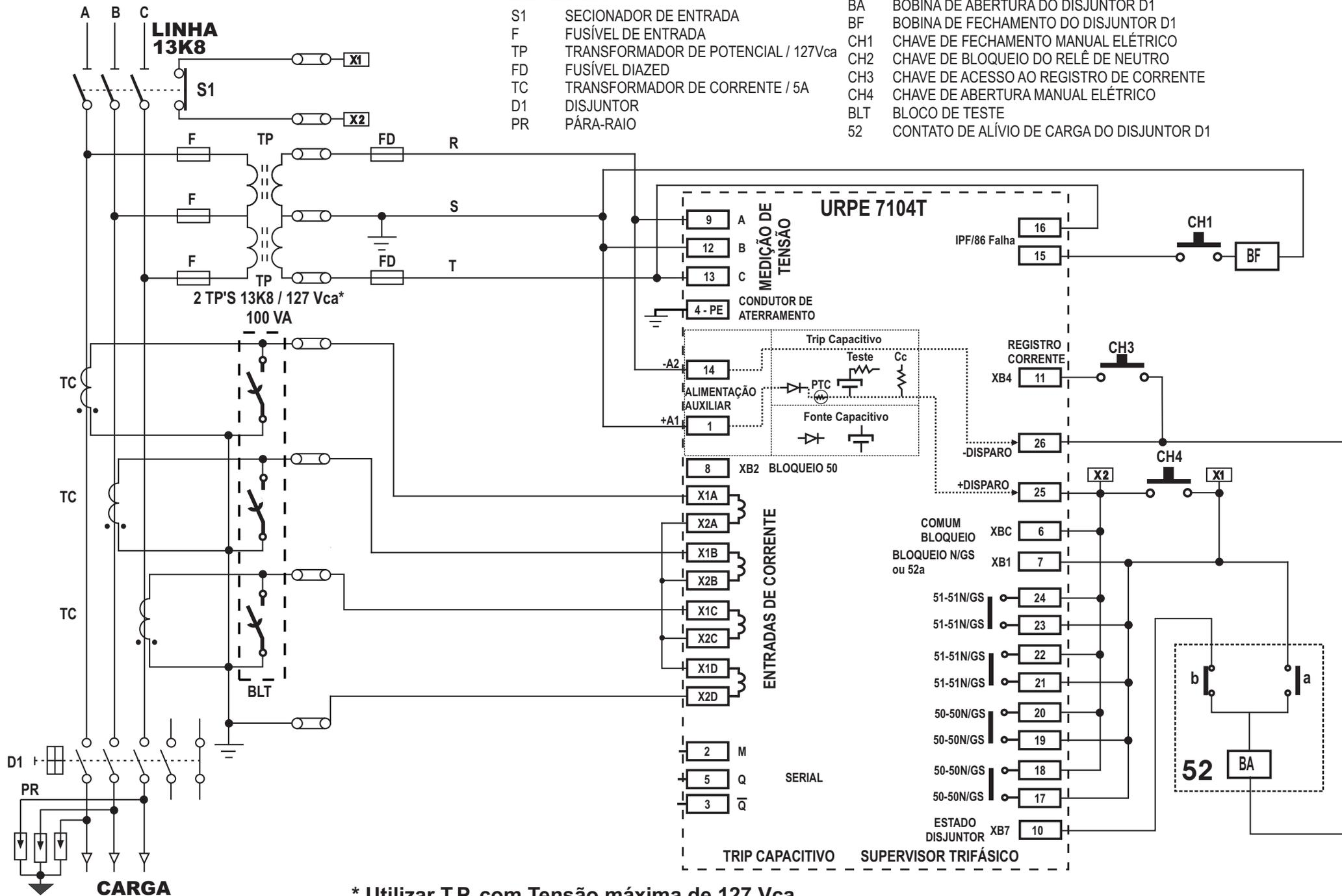
\* Utilizar T.P. com Tensão máxima de 127 Vca.
