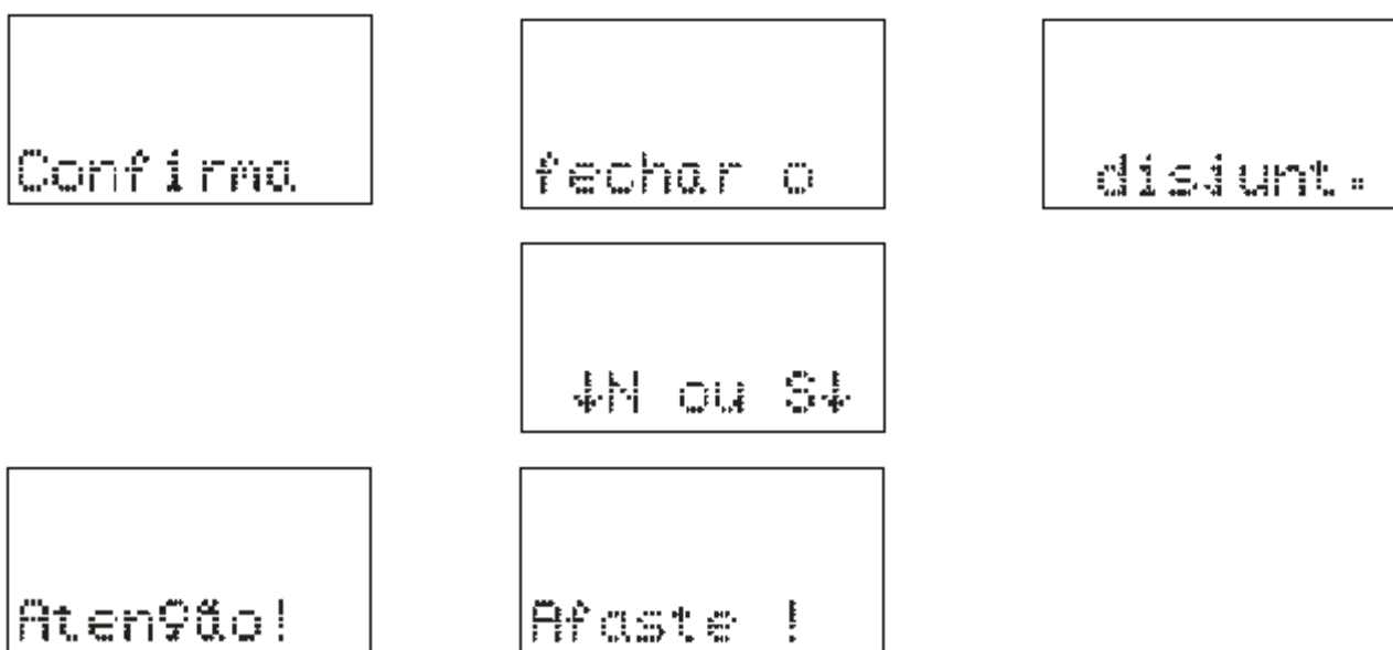
Figura 3.10: Comando local para fechar o disjuntor.
