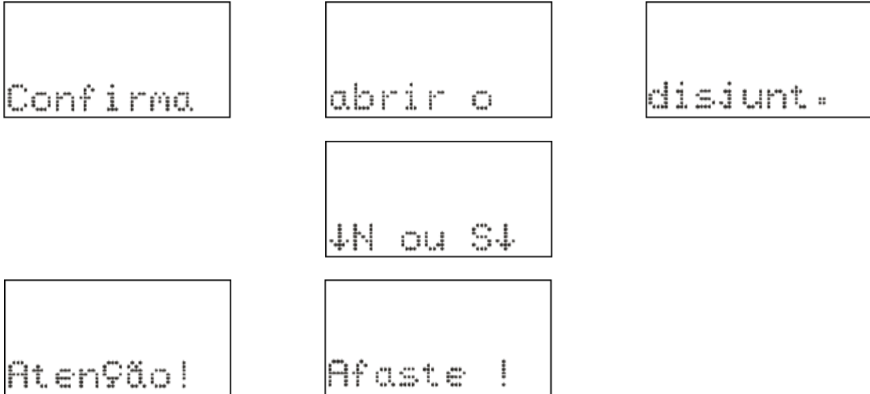
Figura 3.12: Comando local para abrir o disjuntor.
