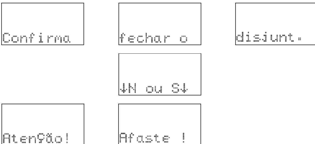
Figura 3.10: Comando local para fechar o disjuntor.
