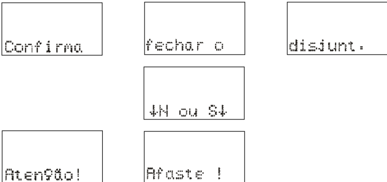
Figura 3.10: Comando local para fechar o disjuntor.
