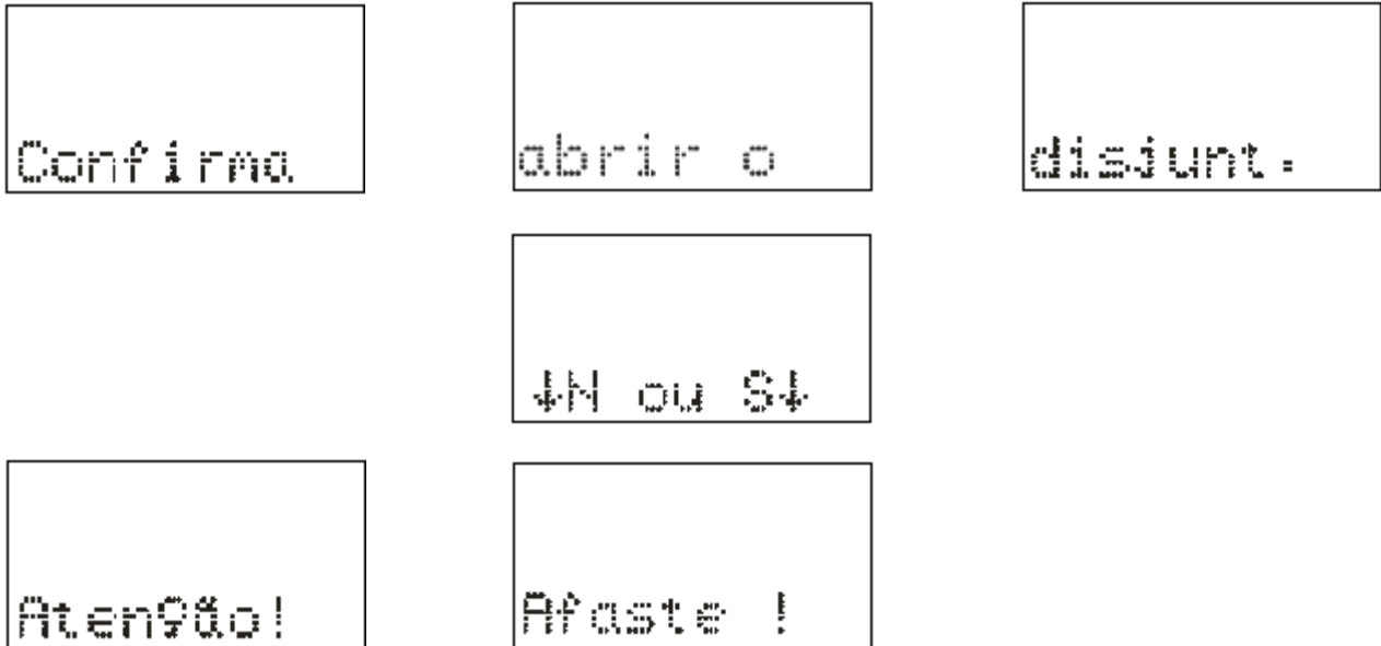
Figura 3.12: Comando local para abrir o disjuntor.
