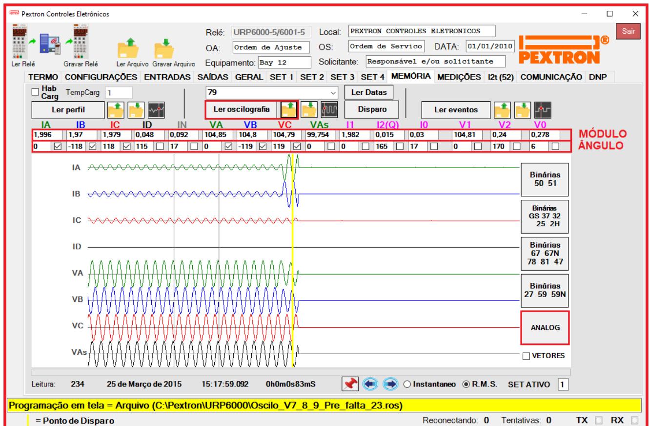
Figura 21.2: Pasta MEMÓRIA com leitura de registro de oscilografia.
