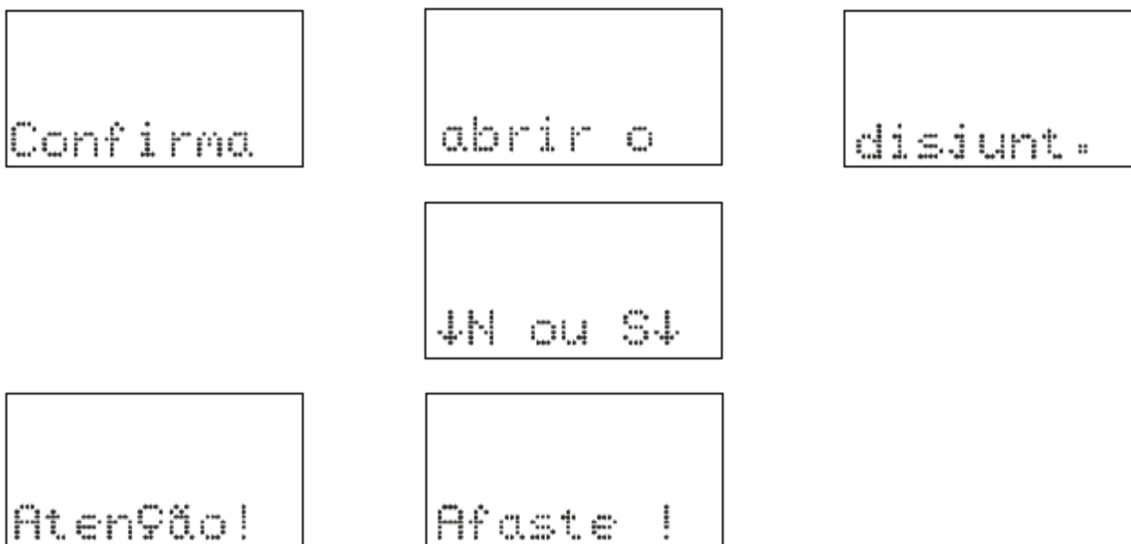
Figura 3.12: Comando local para abrir o disjuntor.
