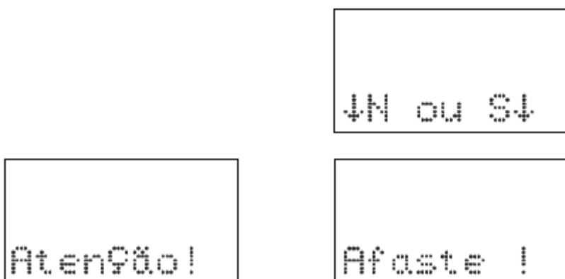
Figura 3.10: Comando local para fechar o disjuntor.
