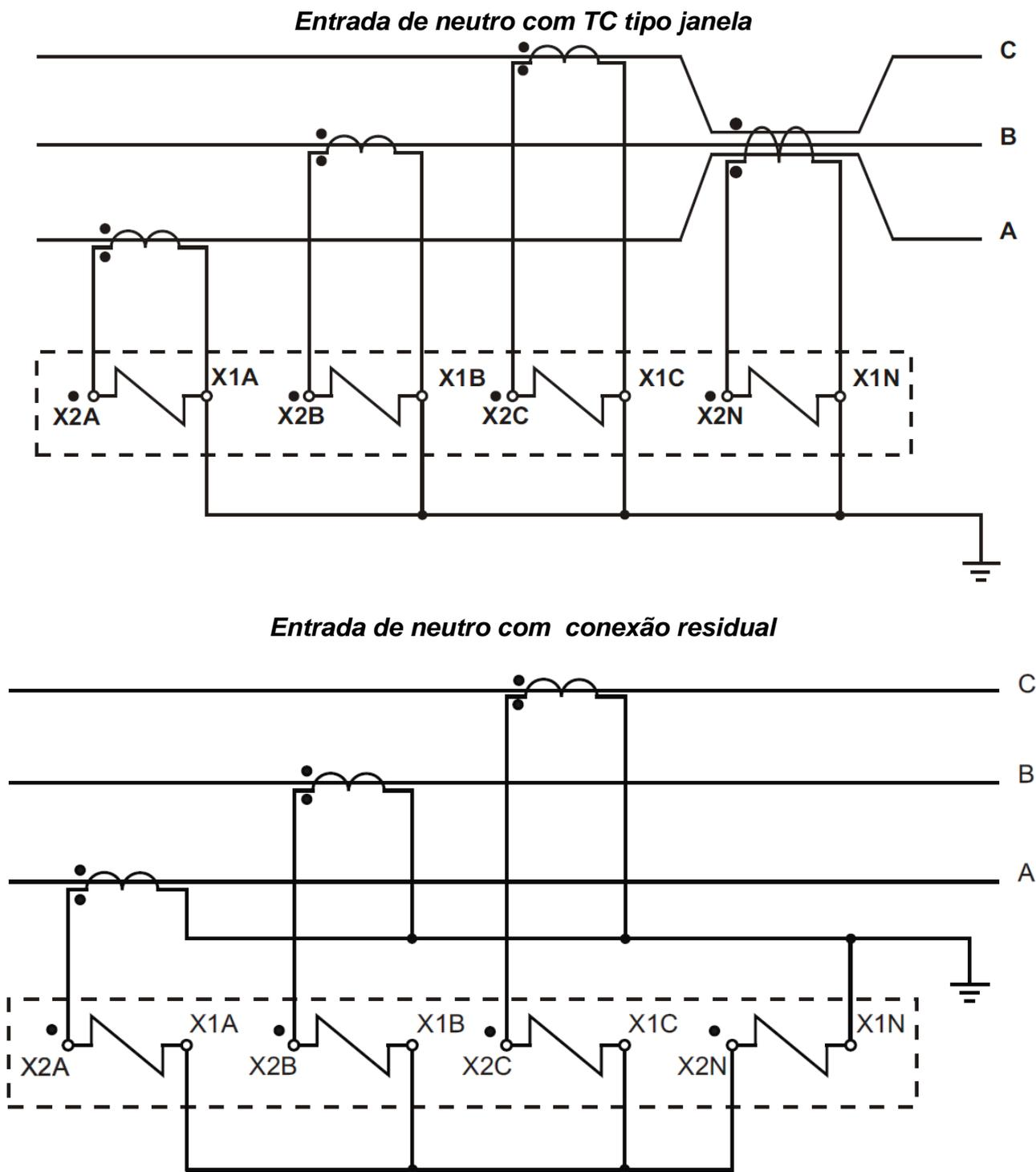
Figura 2: Entrada de neutro em conexão residual ou utilizando um TC tipo janela.
