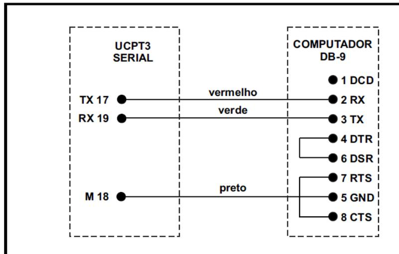
**Nota:** nos bornes da comunicação serial do relé utilizar cabo tipo manga com blindagem trançada (cabo AF 4 x 28 AWG ou AF 4 x 22 AWG).
