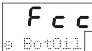
Sensor de temperatura em curto
